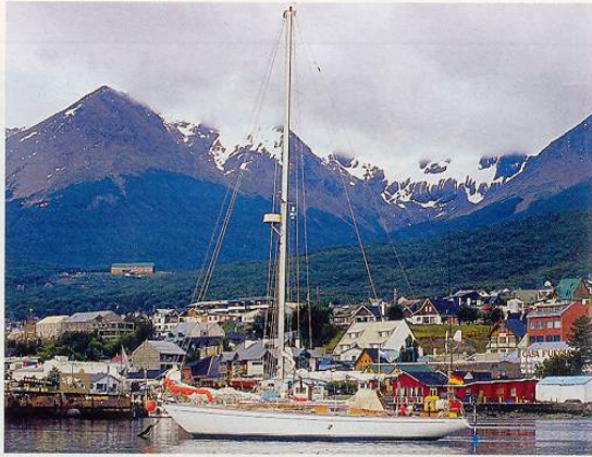
„Ole Hoop“ bei ihrer vorigen Reise ins Kap-Hoorn-Gebiet. Länge 11,44 Meter, Breite 3,14 Meter, Tiefgang 1,75 Meter, Verdrängung 7,0 Tonnen, Segelfläche am Wind 70 Quadratmeter, Rumpf GFK, Deck und Aufbauten Holz, Baujahr 1969, Konstrukteure/Werft Gebrüder Ohlson, Göteborg
