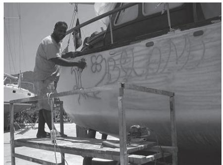
Zweite Lackierung, hier kommt der Kontrollack auf die Oberfläche. Wie konnte das passieren? Ein Monteur am Nachbarboothat die Z-Antriebe mit silikonhaltigem Spray
