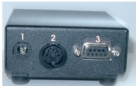
Anschluss 1 wird an der ReLay-Box mit dem Anschluss „Landold Power“ verbunden, Anschluss 2 “ wird an der ReLay-Box an den Anschluss Landold Mic angeschlossen, Anschluss 3 wird an den PC an COM1 angeschlossen.
