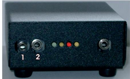
Anschluss 1 wird am PC an „Line In“ (blau) angeschlossen, Anschluss 2 wird am PC an „LineOut“ (grün) angeschlossen
